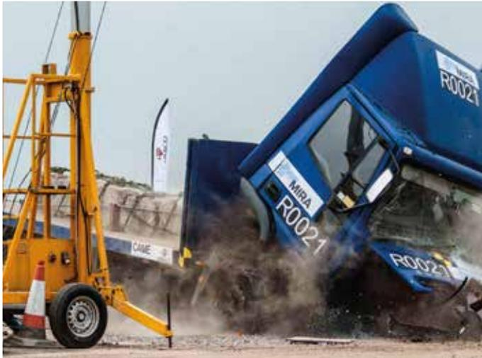
Urbaco hat als erster Hersteller der Welt denselben Poller zwei aufeinanderfolgenden Crash-Tests (mit einem LKW des Typs N3C und einem des Typs N2A), die den neuesten internationalen Bezugsnormen (IWA 14-1:2013 et PAS68:2013) entsprechen, unterzogen. Im Crash-Test wurde der Aufprallwiderstand und die von ONE50<sup>EVO</sup> gewährleistete Sicherheit bestätigt. Der Poller bleibt, auch nachdem er mehreren LKWs widerstanden hat, weiter funktionstüchtig.
